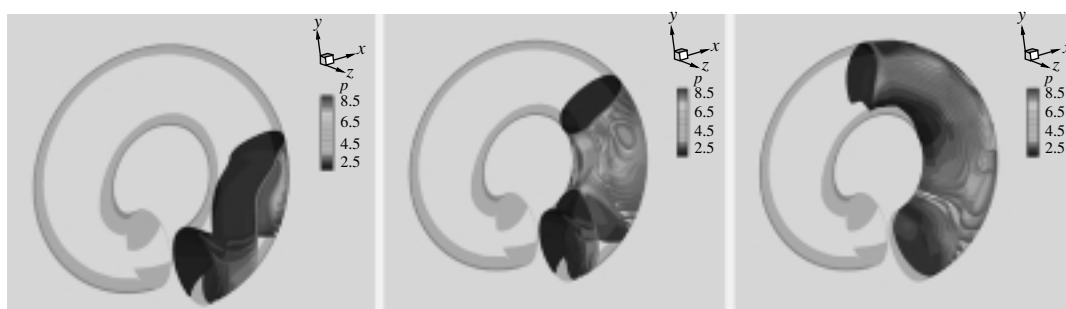
Рис. 8. Расчетная динамика изоповерхностей статического давления (в МПа) при ПГД в витке трубы диаметром 36 мм (вторая конфигурация) при числе Маха первичной УВ M = 3.8 .
